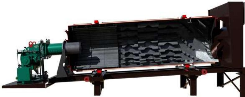
El potente tambor de alta eficiencia y bien equilibrado está aislado y tiene paletas en V de Astec para mejorar la transferencia de calor en el agregado. Un solo chasis aloja al tambor de secado. La tracción del tambor secador de cuatro ruedas es impulsado por una rueda de fricción.
